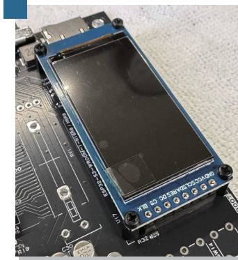
液晶を配置し、ピンをはんだ付け Place LCD and solder pins
